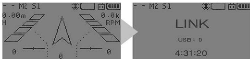
드라이버가 설치 된 후 활성화 되면 리모컨의 화면이 왼쪽에서 오른쪽으로 바뀌면서 **[링크 모드]**로 전환됩니다. **[링크 모드]**에서 **드론 시뮬레이터** 및 **로켓 브릭**이나 **파이썬** 사용할 수 있으며, 펌웨어 업데이트 또한 가능합니다.
